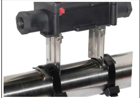
3: Eine **Edelstahlhalterung für versetzte Montage an Rohrleitung**, damit das Gehäuse nach Anbringung der Isolierung und des Schutzes verriegelt werden kann. Für eine Isolierungstärke von **50mm** und kann an heißen Rohren verwendet werden. Klemmung an Metall- oder PVC-Rohrleitungen durch Nylonbinder oder Metallklemme. (Beine als Zubehör erhältlich.)
