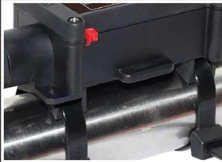
2: Zwei abnehmbare Beine zur **Anpassung an Rohre**, mit einem Versatz von **10mm** zum Rohr. Ideal und wirtschaftlich für Anwendungen mit geringer Isolierungsdicke und einer Rohrtemperatur unter **100°C**. Die Befestigung an Metall- oder PVC-Rohren kann mit einem Nylonband oder einer Metallklemme erfolgen (diese Ösen sind standardmäßig enthalten).
